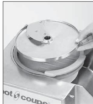
2) Anschließend die jeweilige Schneidescheibe darauf legen. Drehen Sie sie im Uhrzeigersinn zur Feststellung der korrekten Montage.
