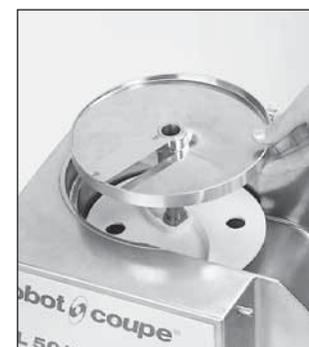
a) **Sie haben eine Reibe-, Streifen- oder Schneid-scheibe gewählt.** Stecken Sie die Scheibe auf die Antriebsachse und drehen Sie sie im Uhrzeigersinn, um festzustellen ob sie richtig sitzt.
