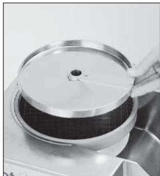
Anschließend die entsprechende Schneidescheibe einsetzen (Scheibe mit gerader Klinge) und diese im Uhrzeigersinn drehen, um sicherzugehen, dass sie richtig sitzt.
