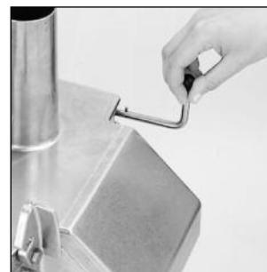
5) Setzen Sie den Deckel des Gemüseschneideaufsatzes auf den Motorblock, so daß sich der Feststellhaken rechts an der Vorderseite des Gerätes befindet.
