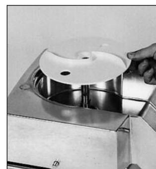
1) Stellen Sie sich vor den Motorblock, und setzen Sie die Gemüseschneideschüssel auf den Motorblock, so daß der Auswurf nach rechts und etwas nach hinten gerichtet ist.
