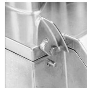
6) Führen Sie den Scharnierstift in die Öffnungen an der Rückseite des Motorblocks ein. Verriegeln Sie den Deckel mit Hilfe des Feststellhakens. Ihr Gerät ist nun betriebsbereit. Die **Modelle R 502 und R 652** arbeiten im Gemüseschneidebetrieb nur mit der niedrigen Drehzahl (750 U/min). In diesem Fall ist der Drehzahlwähler unwirksam. Beim **Modelle R 502 V.V. und R 652 V.V.** stellt sich der für den Gemüseschneidebetrieb zulässige Drehzahlbereich (300 bis 1000 U/min) automatisch ein.
