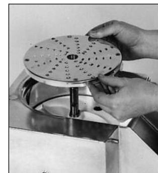
**a) Schneide-, Reibe- oder Streifenscheibe :** Setzen Sie die Scheibe auf die Antriebswelle und drehen Sie sie im Uhrzeigersinn, um zu prüfen, ob sie richtig sitzt.
